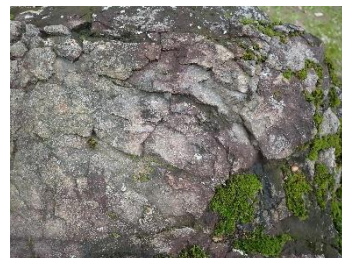
図2 安山岩に見られる表層の小片化
