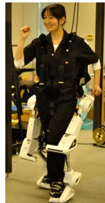
試験装置「パワーローダーライト」 (アクティブリンク(株)製)
