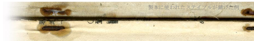
劣化して浸み込むテープ
