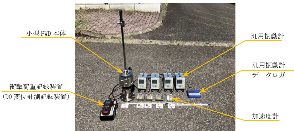
図2 小型FWDシステムのシステム構成
