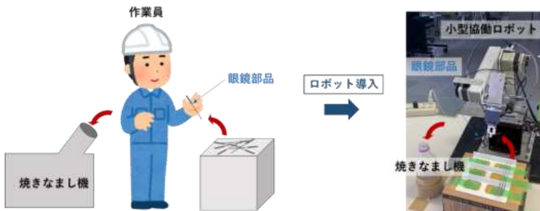
図4 小型協働ロボットによる自動化デモ動作
